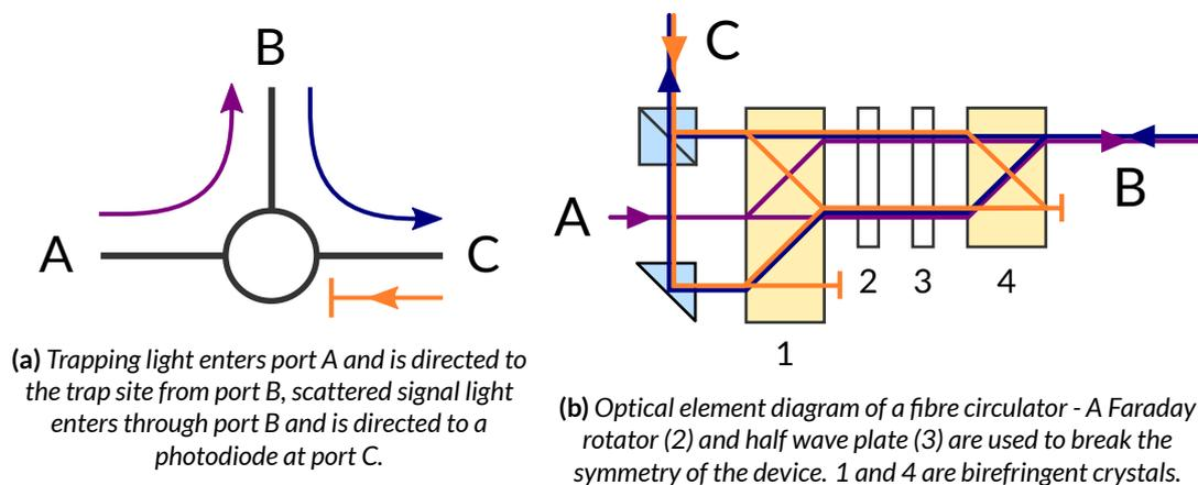
Fig. 4.10. Fibre optic circulator
